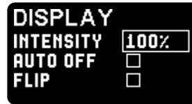
INTENSITY (intensité) modifie la luminosité de l'écran. L'éventail des valeurs s'étend de 0 à 100% par pas de 10%. Une valeur de 0% correspond à l'intensité minimale de l'écran (les pixels restent visibles).
