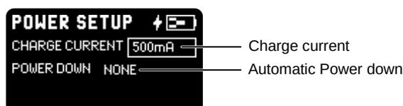
Un courant de charge maxx de 500mA ou 1A peut être sélectionné. La valeur par défaut est 500mA.
