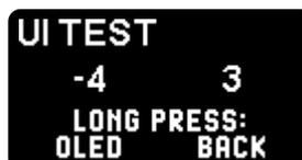
Les deux chiffres situés au milieu de l'écran sont des compteurs. Utilisez-les pour tester les encodeurs rotatifs. En les tournant dans le sens horaire, le compteur augmente, et il diminue dans le sens anti-horaire. Une courte pression sur l'encodeur met en évidence son compteur.
