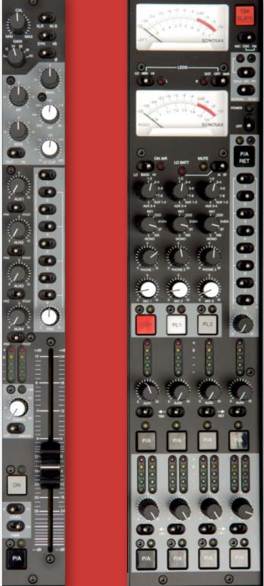
Mit den dreistufigen Kippschaltern (etwa in der Bildmitte) lassen sich alle Routingaufgaben in den Channel-Strips (links) und in der Mastersektion souverän bewältigen.
