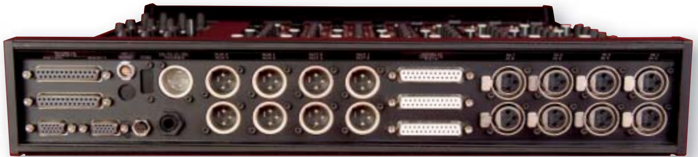
Wegen der beengten Platzverhältnisse auf der Rückseite muss die Mehrzahl der Anschlüsse über Kabelpeitschen und SUB-D-Anschlüsse erfolgen.
